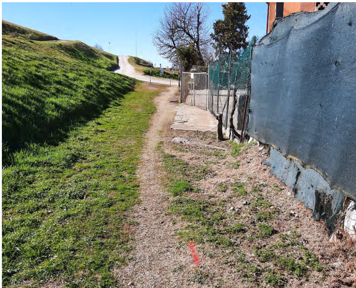
Figura 11 - Tracciamento della linea telefonica interrata in seguito a sopralluogo. Il segno rosso nella foto evidenzia la posizione della linea interrata.
